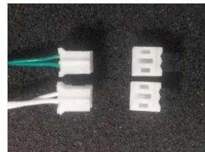
Durch das Abstecken des Jumpers am weißen Kabel wird die Spiegelungsfunktion der Kamera deaktiviert.
