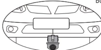
Führen Sie das Kabel durch das Loch und pressen die Kamera samt Dichtung in das Loch.
