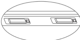
1. Installieren Sie die KCX401 in die Halterung Ihrer Nummernschildbeleuchtung. Demontieren Sie dazu die Halterung und bohren ein 21 mm Loch.
