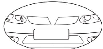
2. Installieren Sie die KCX401 z.B. unter dem Nummernschild in der Front des Fahrzeugs. Bohren Sie dazu ein 21 mm Loch.
