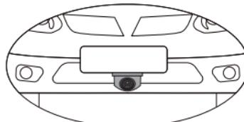
Verlegen Sie das Kabel und schließen es gemäß der auf der nächsten Seite angegebenen Beschreibung an. Danach montieren Sie wieder die Halterung. Bei Variante 2 müssen ggfs. je nach Einbauort (Front oder Heck) zwei Kabelschläufen durchtrennt werden. Da sonst das Bild falsch angezeigt wird. Diese Einstellung bitte mit Hilfe eines Monitors vor der Endmontage prüfen.
