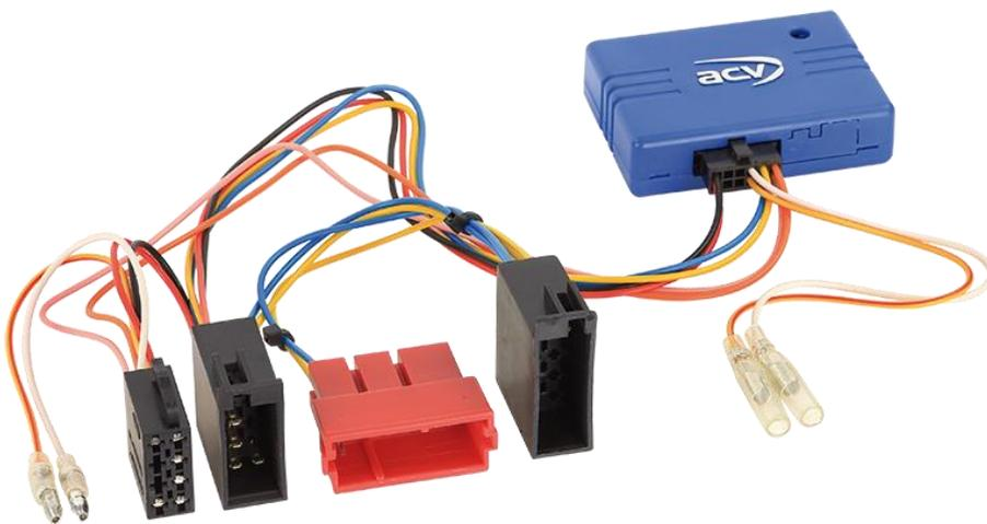
Bei Fahrzeugen mit Lenkradfernbedienung empfehlen wir die Verwendung eines Lenkradfernbedienungsadapters (42smc002) aus dem acv Programm.
