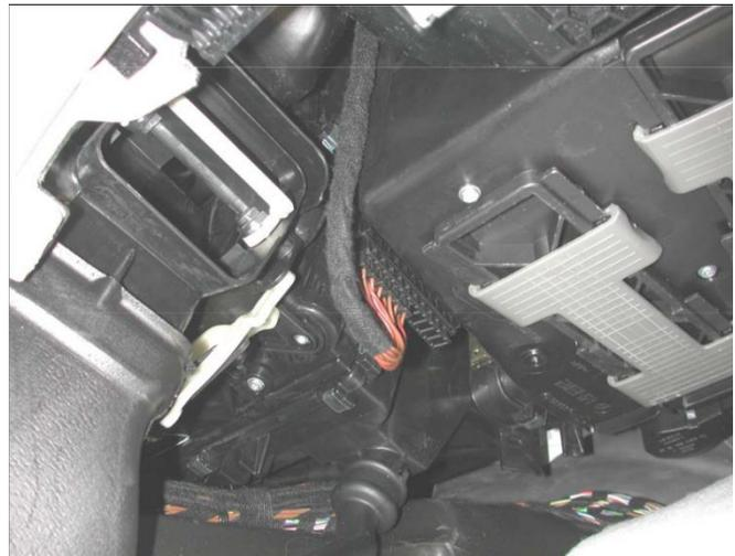
Sollte keiner der CAN BUS Verteiler zugänglich oder auffindbar sein, so können die CAN BUS Leitungen auch manuell mit den Leitungen des Innenraum Comfort CAN BUS verbunden werden.
