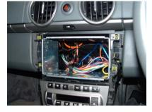
Fit the double din metal bracket.
