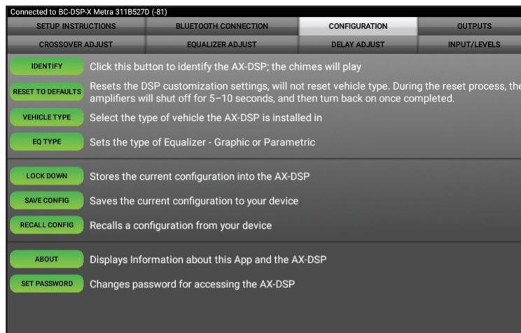
**RESTABLECIMIENTO A VALORES PREDETERMINADOS:** Reinicia la interfaz a sus configuraciones de fábrica. Durante el proceso de reinicio, los amplificadores se apagarán entre 5 y 10 segundos.
