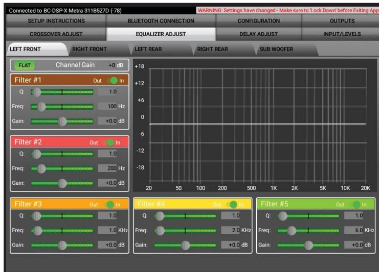
Cada salida cuenta con un **ecualizador paramétrico de 5 bandas** por canal. Cada banda permitirá que el usuario ajuste:
