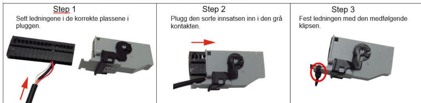
Eksempel på tilkobling av 32-pins tilleggsutstyrsplugg.
